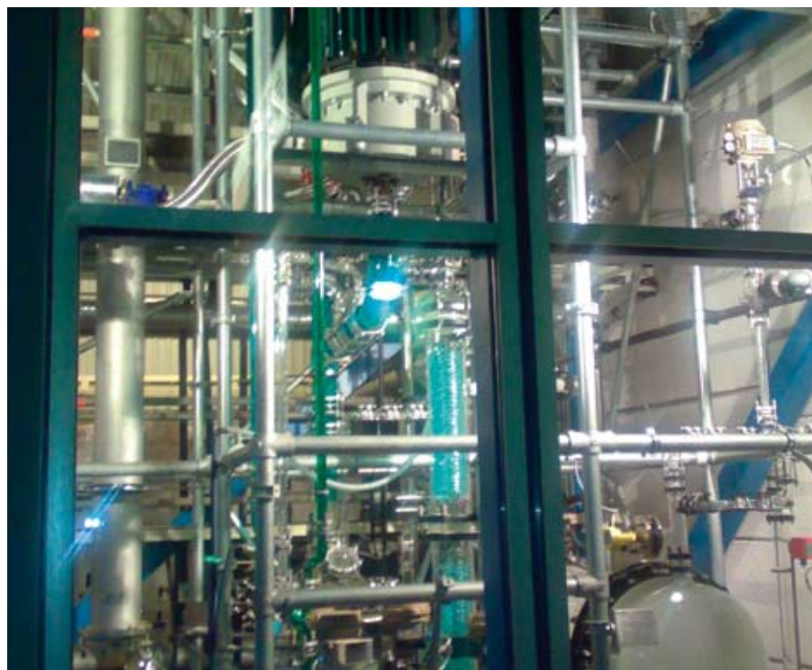
Destillationskolonnen, hvor syreopløsningen renses.
